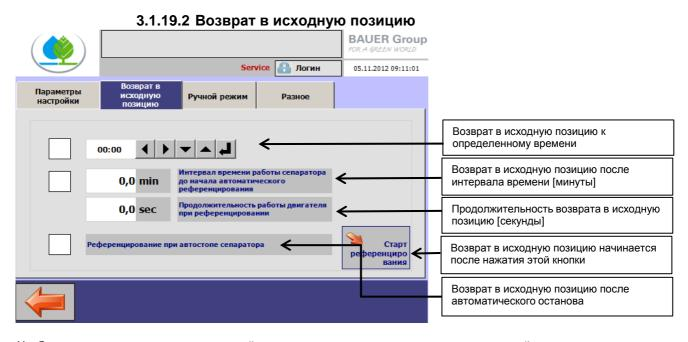
Чтобы определить положение двигателей для регулировки противовесов, должен произойти возврат в исходную позицию. Существует три возможности возврата в начальную позицию.
