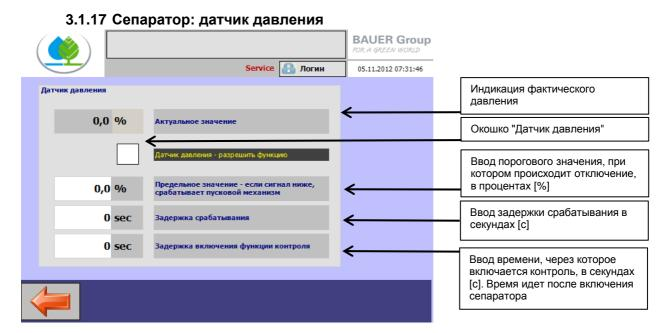
Через датчик давления в подводящем трубопроводе проверяется, подает ли насос в сепаратор среду. Давление на подаче составляет прибл. 0,2 бар. Если давление не создается (нет среды), то сепаратор, шнековый транспортер и насос отключаются, и появляется сигнальное сообщение. Функция контроля активирована на заводе.
