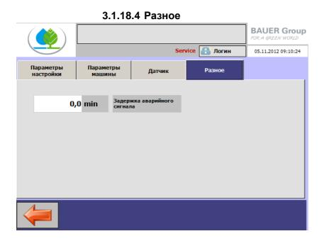
Здесь задается задержка срабатывания, прежде чем на дисплее отобразится предупредительное сообщение. Когда выводится предупреждение, установка продолжает работать.
