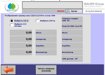
В этом меню могут быть считываться опорные точки ток (С22), скорость вращения (С11) и частота (С59) с частотного преобразователя в панели управления. Для этого нажмите кнопку "Читать опорные значения".
